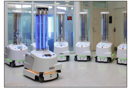
**Figure 04 : Ultraviolet disinfection robots**
